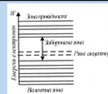
Зонна діаграма напівпровідника p-типу
